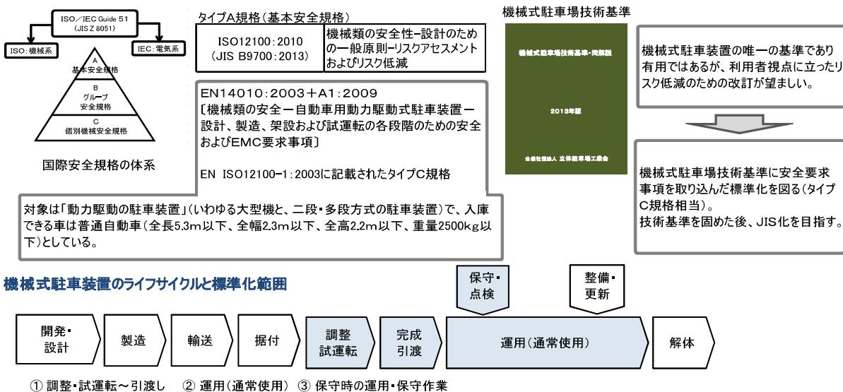
図VII-2 機械式駐車場技術基準の見直しに向けたスキーム
