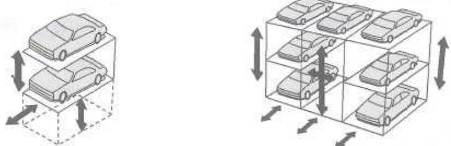
図 I-8 二段方式・多段方式
